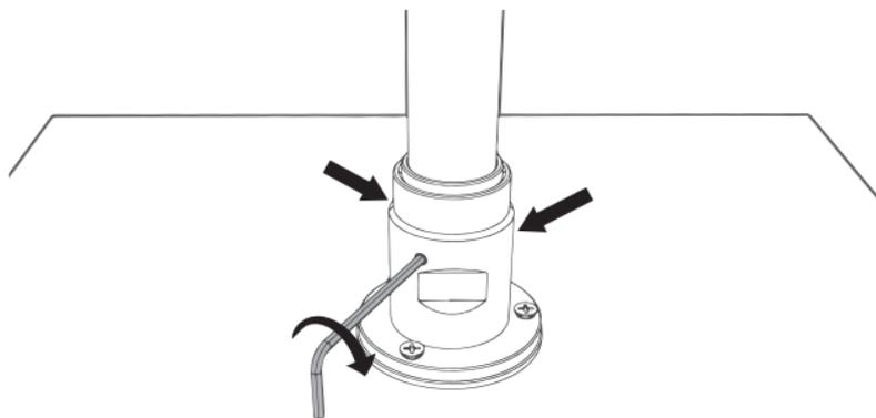
Une fois le bec correctement aligné, verrouillez-le en place en serrant les 3 vis de réglage.
