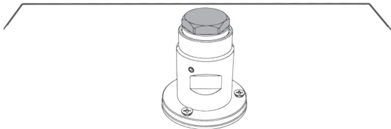
Garder en place tous les capuchons de test et de protection jusqu'au moment d'installer la finition. Une fois les branchements réalisés, ouvrir l'eau pour tester l'étanchéité de tous les joints.
