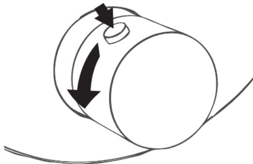
Appuyer sur le bouton de sécurité et tourner la poignée dans le sens anti-horaire jusqu'à l'arrêt.
