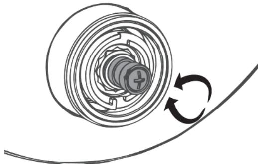
Avec l'aide d'un thermomètre, calibrer la température de l'eau sortant du bec à 48.9°C (max) en tournant la cartouche (partie grisée).
