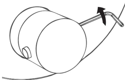
Avec la poignée toujours sous tension à son maximum, serrer la vis à l'aide d'une clé allen pour fixer la poignée.
